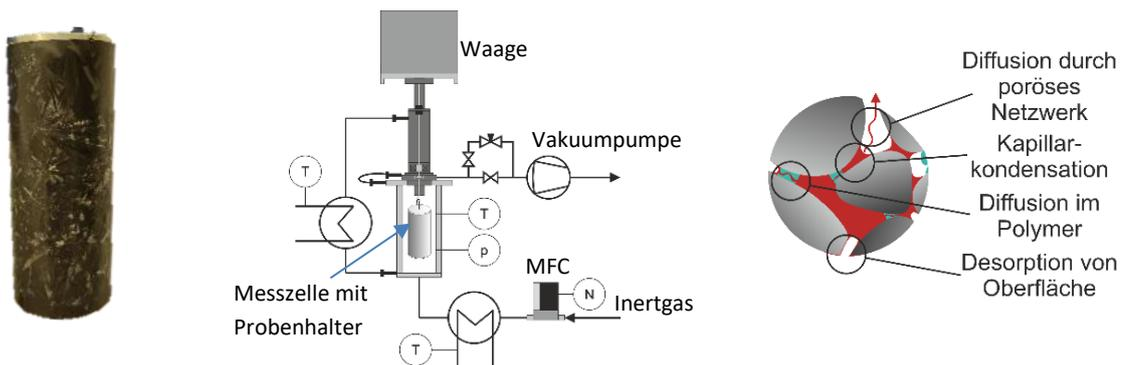
Links: mit Elektrolytlösemittel benetzte Anode auf Probenhalter für die Magnetschwebewaage
