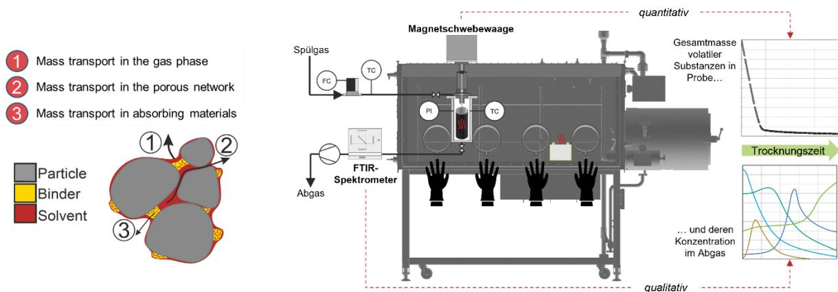
Links: Stofftransportmechanismen bei der Trocknung poröser, sorbierender Materialien.
