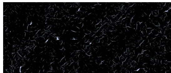
Abb. 2: Defekte (z.B. Risse oder Agglomerate) in einer trockenen Katalysatorschicht
