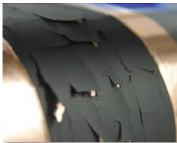
Abbildung 1: Delaminationseffekte in Folge hoher Trocknungsraten.
