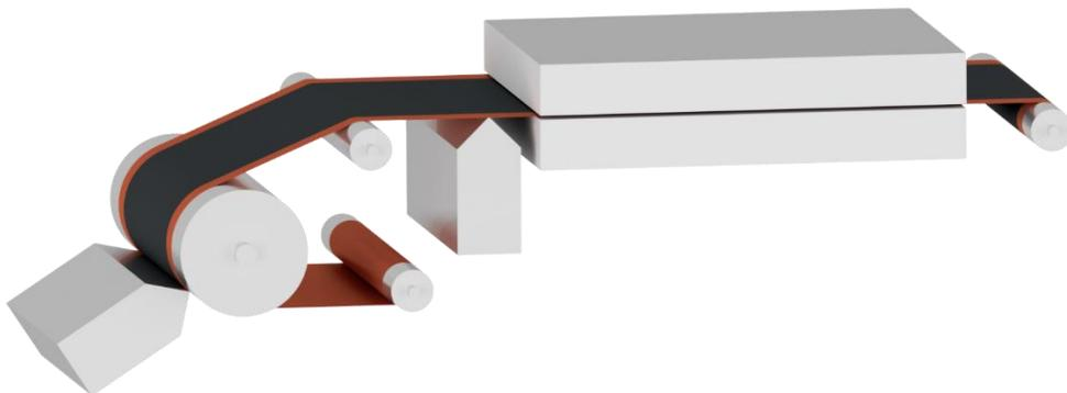
Abbildung: Prozessschema der simultan beidseitigen Beschichtung von Lithium-Ionen-Batterieelektroden.
