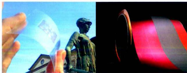
Abb. 1: Polymersolarzelle (links) und beschichtete Elektrode für Lithium Ionen Batterien (rechts)
