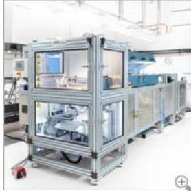
Pilotanlage für organische und gedruckte Elektronik (Foto: Martin Lober, KIT)
