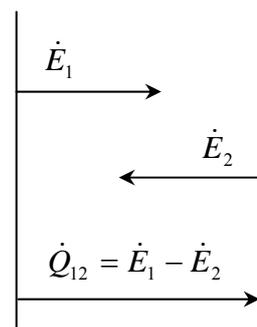
$$\alpha_{rad} = C_{12} \cdot \frac{1}{2} \cdot (T_1 + T_2)^3 \cdot \left( 1 + \left( \frac{T_1 - T_2}{T_1 + T_2} \right)^2 \right); \text{ Annahme: } (T_1 - T_2)^2 \ll (T_1 + T_2)^2, \text{ somit:}$$
