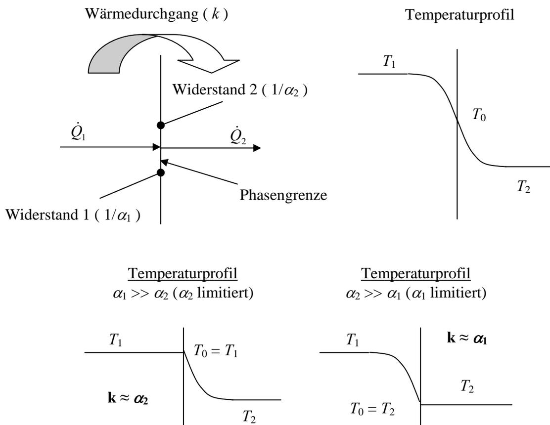
Häufig haben  $\alpha_1$  und  $\alpha_2$  aber die gleiche Größenordnung. Daher müssen bei der Berechnung des Wärmedurchgangs beide Widerstände berücksichtigt werden. Da von einem stationären Zustand ausgegangen wird, ist der Wärmestrom konstant und auf beiden Seiten gleich:
